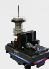
Der Magic Trolley ist ein Aufsatz für ein automatisches Flurfördersystem (FTS) mit einem Pick-per-Light- Regal für KLT Behälter.
